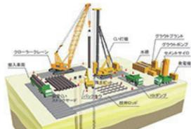
専用の掘削攪拌装置により掘削液を注入しながら地盤を掘削攪拌し、所定深度まで泥土化させた掘削孔を築造します。支持層内で拡大掘削・根固め液を注入して拡大球根を築造した後、杭周固定液を注入攪拌しながら掘削攪拌装置を引き上げ、ソイルセメント柱を築造します。その中に鋼管杭を建て込み自沈または回転圧入により所定深度まで埋設する工法です。
